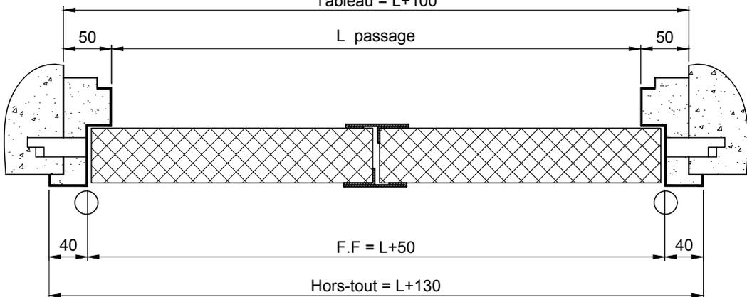
**ATTENTION: Le calfeutrement du bâti doit être réalisé au mortier de ciment.**
