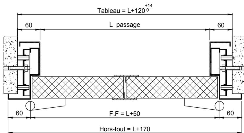
**ATTENTION: Le calfeutrement du bâti doit être réalisé au mortier de ciment.**
