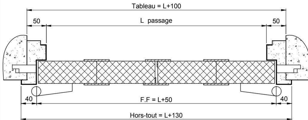
**ATTENTION: Le calfeutrement du bâti doit être réalisé au mortier de ciment.**
