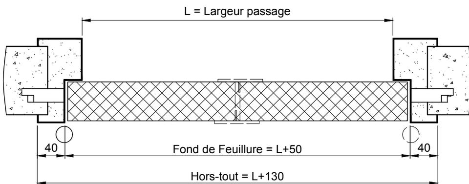
**ATTENTION: Le calfeutrement de la cloison doit être réalisé au mortier de ciment.**
