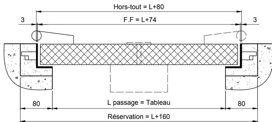
**ATTENTION: Le calfeutrement du bâti doit être réalisé au mortier de ciment.**
