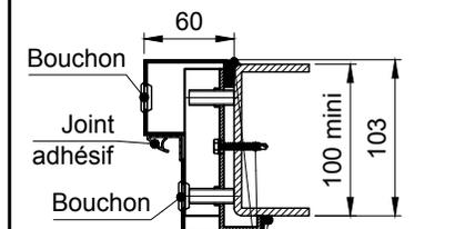
Soudure et/ou vis autoperceuse TH6.3 (non fournie)
