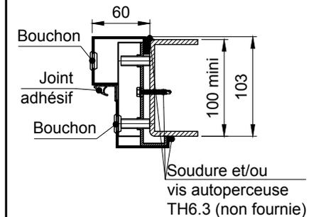
Soudure et/ou vis autoperceuse TH6.3 (non fournie)
