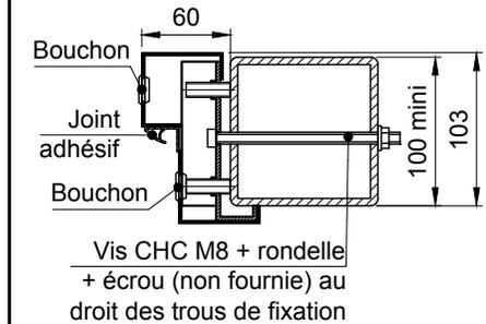
Vis CHC M8 + rondelle + écrou (non fournie) au droit des trous de fixation
