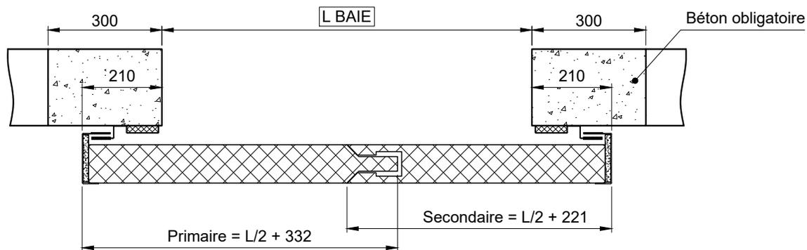
Rail à installer en pente de 1 à 2% pour assurer la fermeture par gravité du vantail
