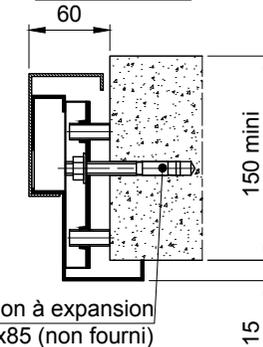
Goujon à expansion M10x85 (non fourni) au droit des trous de fixation
