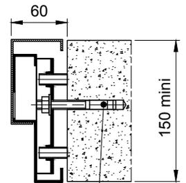
Goujon à expansion M10x85 (non fourni) au droit des trous de fixation
