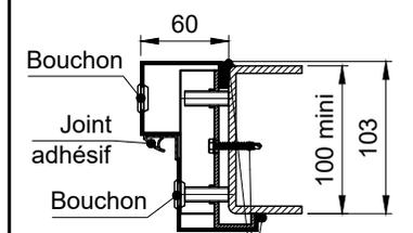
Soudure et/ou vis autoperceuse TH6.3 (non fournie)
